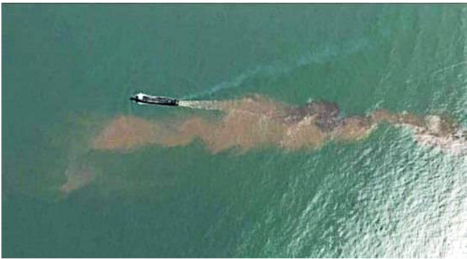
Figura 3. Utilização do recurso do overflow no processo de dragagem. Fonte: https://www.grupoceano.com.br/site/index.php?n_sistema=8024&id_noticia=OTE5Mw== .
